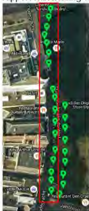
Figuur 2: locaties prisma's aan werfmuur rak 3 [Bron: WePGIS]
